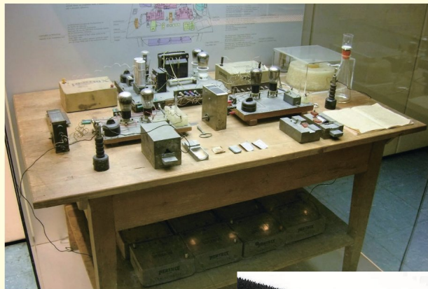
ドイツのミンヘン博物館で再現されたオットー・ハーンやリーゼ・マイトナーがウランの核分裂反応を発見するために用いた1938年当時の核分裂実験装置 (Wikimedia commonsから)
