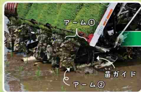
アーム②が苗を植えたところ。アーム①は苗のせ台から、苗を引きぬいたところ。
